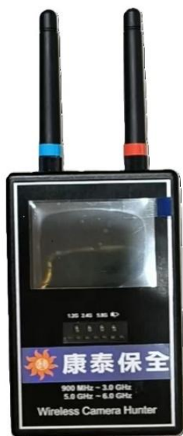
RF 類比訊號偵測器 50 米攔截類比無線訊號 影像
